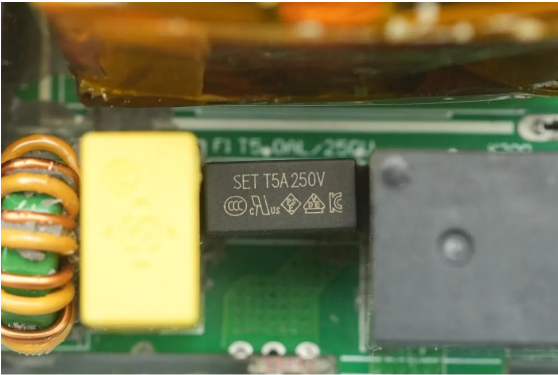
保险丝来自赛尔特，为SPT478系列慢速熔断器，规格为T5A 250V。
